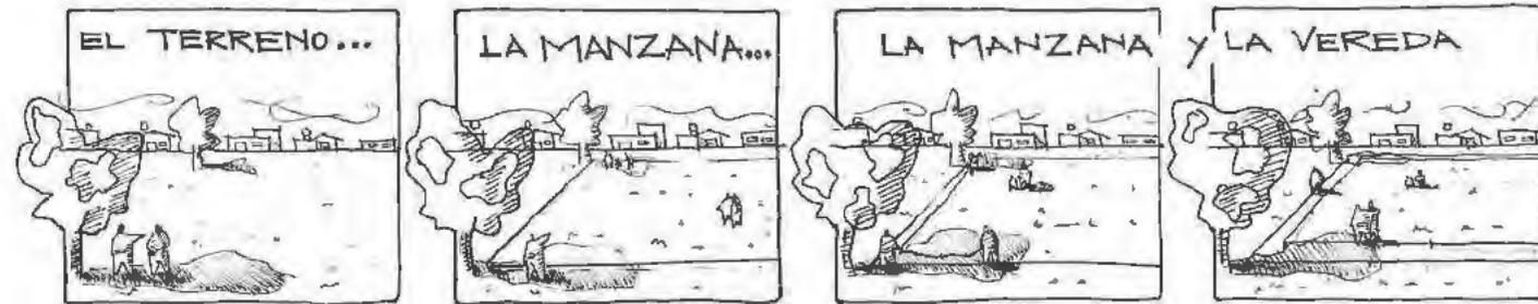
Paso 1: Para trazar en el terreno lo dibujado, usando las sogas con las que medimos el terreno, buscaremos otra vez un punto fijo (que puede ser el mismo que usamos para medir el terreno o puede ser otro cualquiera: un muro, donde termina la vereda, un árbol, etc.), ese será nuestro punto de referencias 0.
